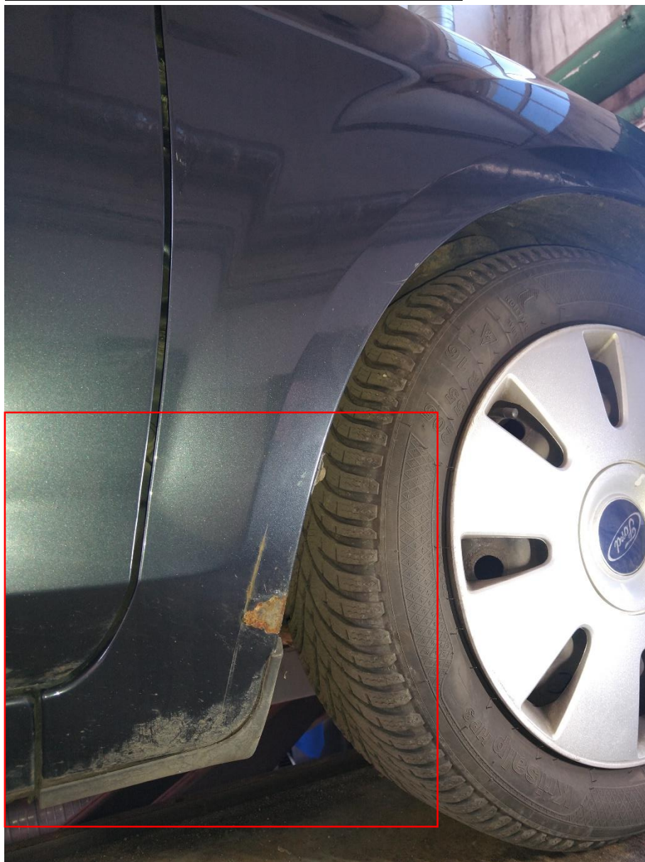
Trzecie ognisko korozji: przedni prawy próg/ nadkole
