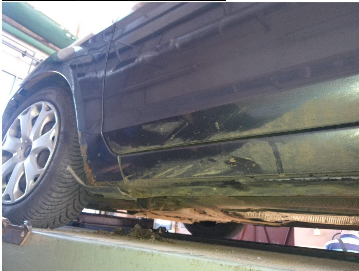
Drugie ognisko korozji: przedni próg/nadkole po lewej stronie
