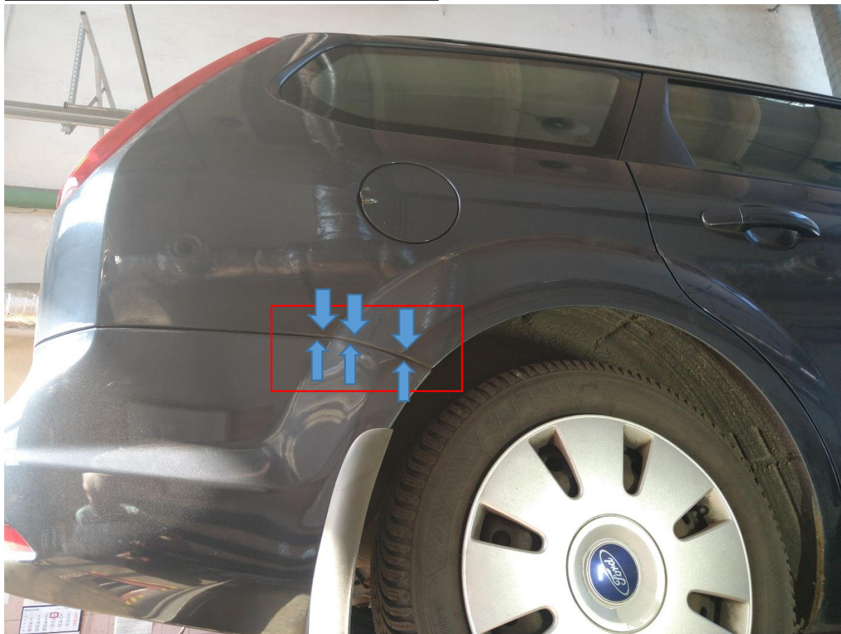
Czwarte ognisko korozji: tylne prawe nadkole/próg
